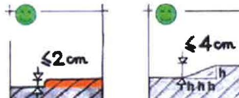
Si la marche est supérieure à 4 cm, l'entrée doit être équipée d'une rampe permanente avec un palier de repos horizontal devant la porte ou d'une rampe amovible assortie d'un dispositif d'appel (sonnette située entre 0,90 m et 1,30 m du sol).
